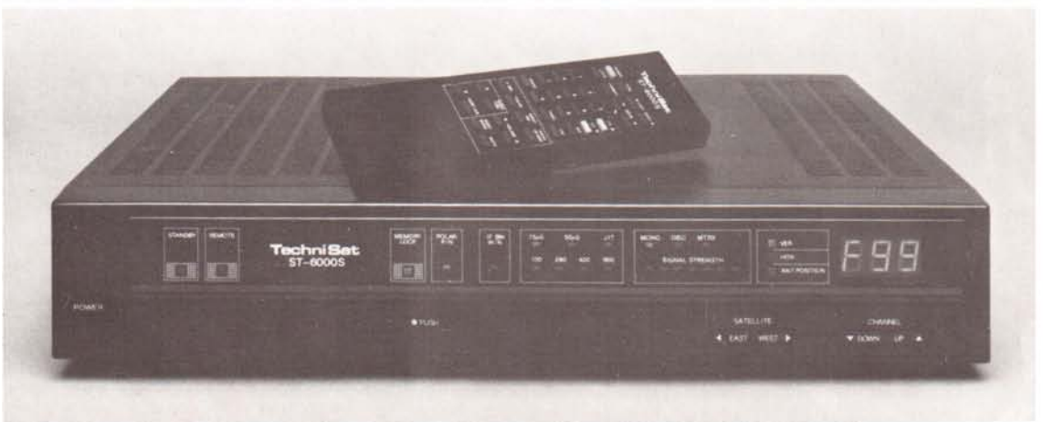
Bild 20: TechniSat-Receiver ST-6000 S, IR-fernbedienbar, Programmierung für 99 Speicherplätze und 29 Satellitenpositionen, Anschlußmöglichkeit für Ferrit- und mechanische Polarizer, Umschaltmöglichkeit für 11- und 12,5-GHz-LNC, 950 bis 1750 MHz Eingangsfrequenz, zwei ZF-Eingangsfrequenzen, zwei ZF-Bandbreiten, S-Meter, Stereo ... (Foto TechniSat)
